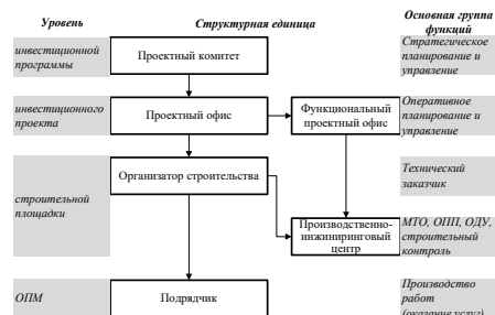
Рис. 4. Структурно-функциональная декомпозиция инженеринговой схемы управления
