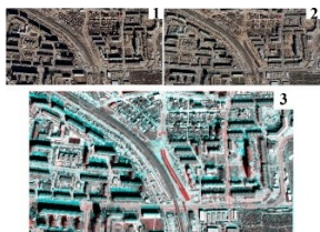
Рис. 1. Совмещение разновременных спутниковых снимков в программном комплексе ENVI (1 – 2007 г.; 2 – 2020 г.; 3 – спектральное совмещение снимков)
