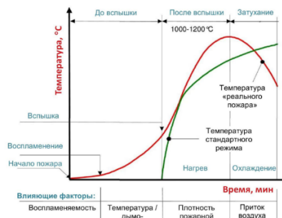
Рис. 3. Сравнение температурных режимов реального пожара и стандартного испытания на огнестойкость
