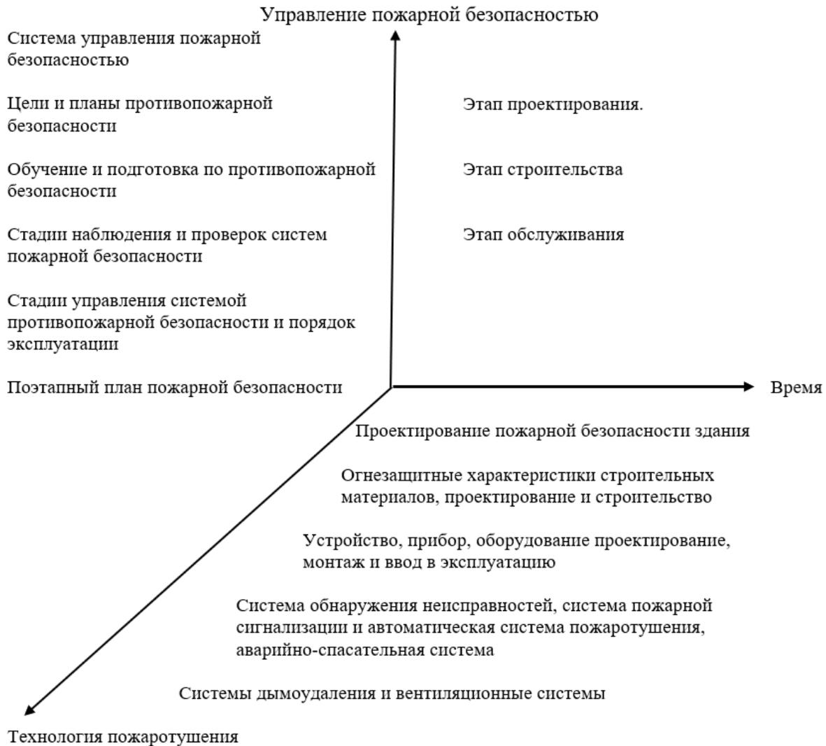
Рис. 4. Состав противопожарной системы высотного здания
