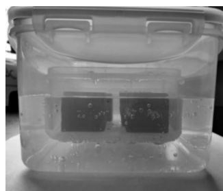
Рис. 3. Исследуемые образцы в среде углекислого газа
