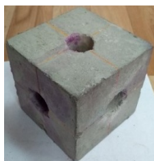
Рис. 5. Окрашивание щелочных зон бетона раствором ализарина по стенкам контрольных отверстий на образцах – бетонных кубиках 10 × 10 × 10 см
