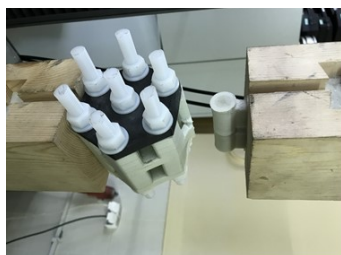
Рис.8. Узел после испытания на разрыв
