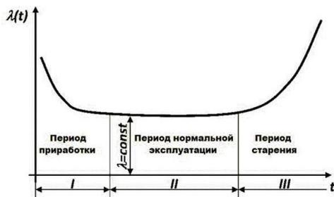
Рис. 1. Типичное изменение интенсивности отказов
