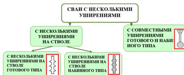
Рис. 8. Классификация конструкций свай с несколькими уширениями на стволе в зависимости от технологии изготовления
