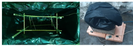
Рис. 1. Каркас внутри формы с закрепленной на нем проволокой (а); общий вид прогреваемого образца (б)
