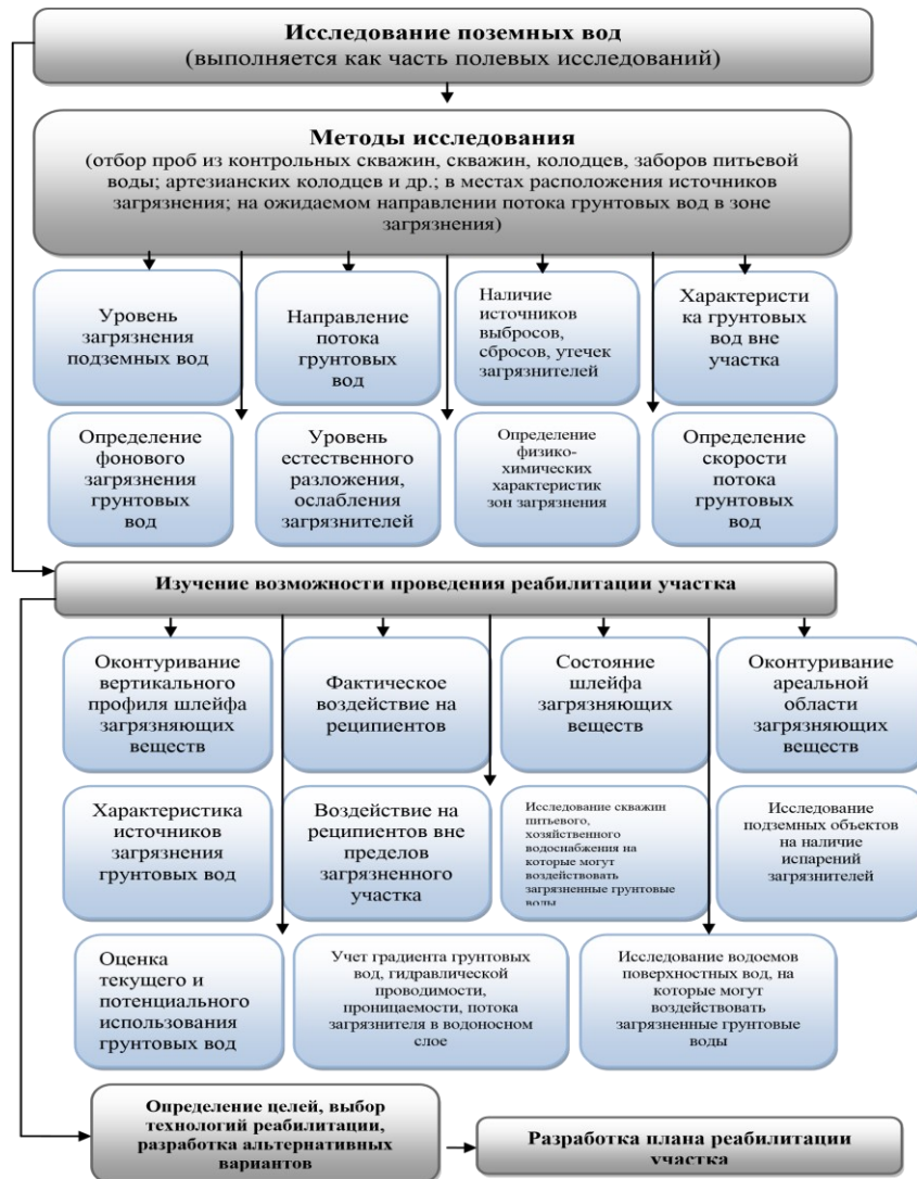
Рис. 3. Процесс исследования подземных вод на производственных территориях и территориях нежилой застройки для подготовки плана рекультивации [9]
