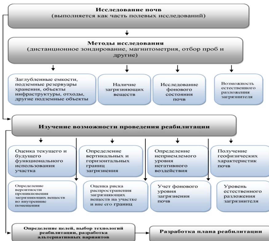
Рис. 2. Процесс исследования почв на производственных территориях и территориях нежилой застройки для подготовки плана рекультивации [9]
