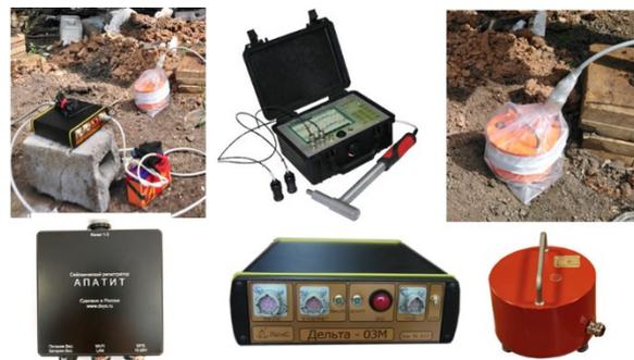
Рис. 1. Общий вид комплектов аппаратуры сейсмических зондирований
