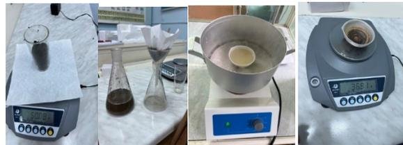
Рис. 8. Взвешивание на электронных весах исходного образца почвы, приготовление водной вытяжки, выпаривание водной вытяжки на водяной бане и определение засоленности почв по сухому остатку
