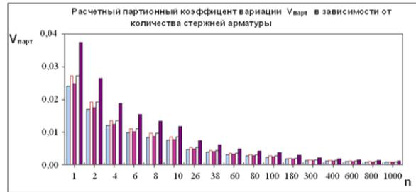
Рис. 3. Диаграмма  $V_{part}$  - количество стержней арматуры  $n$
