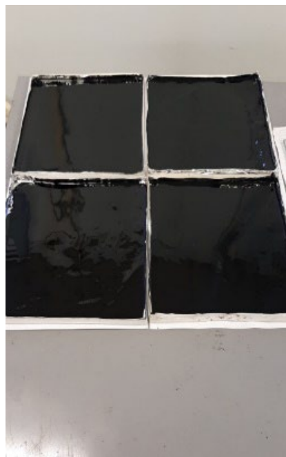
Рис. 2. Внешний вид контейнеров для УФ-старения до (слева) и после (справа) их заполнения битумными вяжущими
