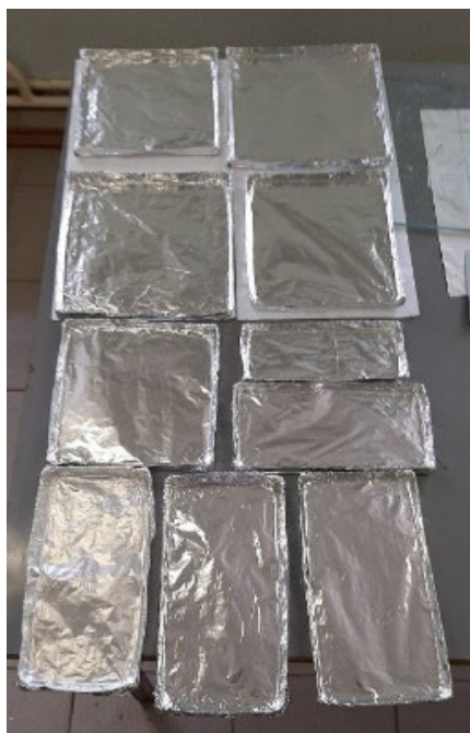
Рис. 2. Внешний вид контейнеров для УФ-старения до (слева) и после (справа) их заполнения битумными вяжущими
