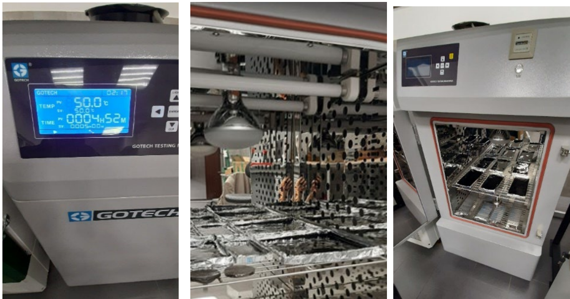
Рис. 1. Внешний вид камеры светового старения GOTECH GT-7035-EUAB (слева), расположение ламп солнечного света и УФ-излучения (в центре), а также пример размещения образцов в камере (справа)
