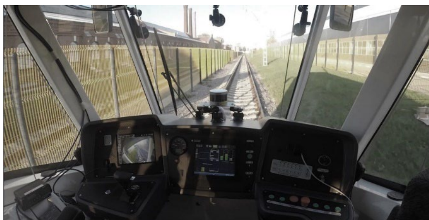
Рис. 9. Тестирование на закрытой территории трамвайного депо беспилотного трамвая «Львенок – Москва»
