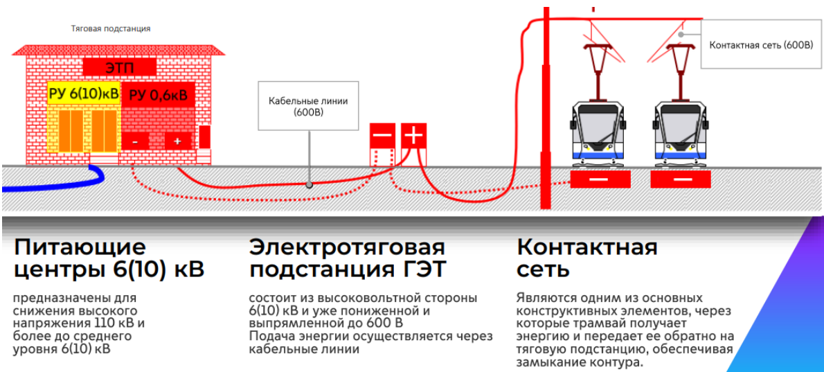
Рис. 7. Принципы работы системы электроснабжения трамвайной сети
