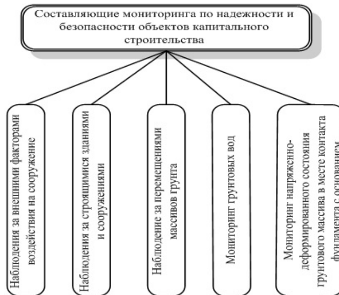
Рис. 1. Компоненты мониторинга объектов капитального строительства
