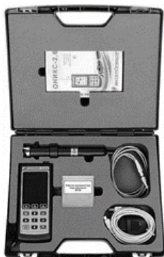
Рис. 2. Прибор портативный ОНИКС-2.5 для определения прочности ударно-импульсным методом по ГОСТ 22690-2015
