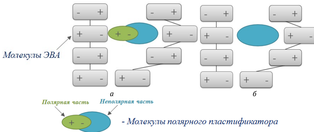
Рис. 7. Схематическое изображение взаимодействия ЭВА с: а – полярным и б – слабополярным пластификаторами
