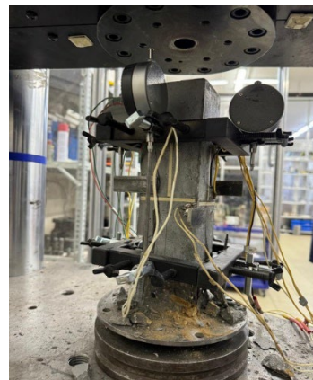
Рис. 2. Призмы 100 \times 100 \times 400 из легкого высокопрочного бетона с встроенными термопарами ТПК 011 05/1
