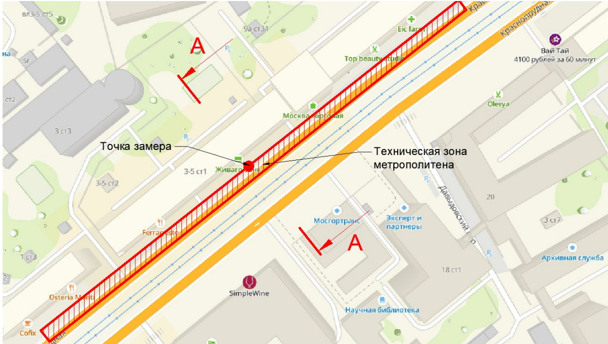
Рис. 5. Схема расположения точек замеров вибрации от наземного и подземного транспорта по ул. Краснопрудная
