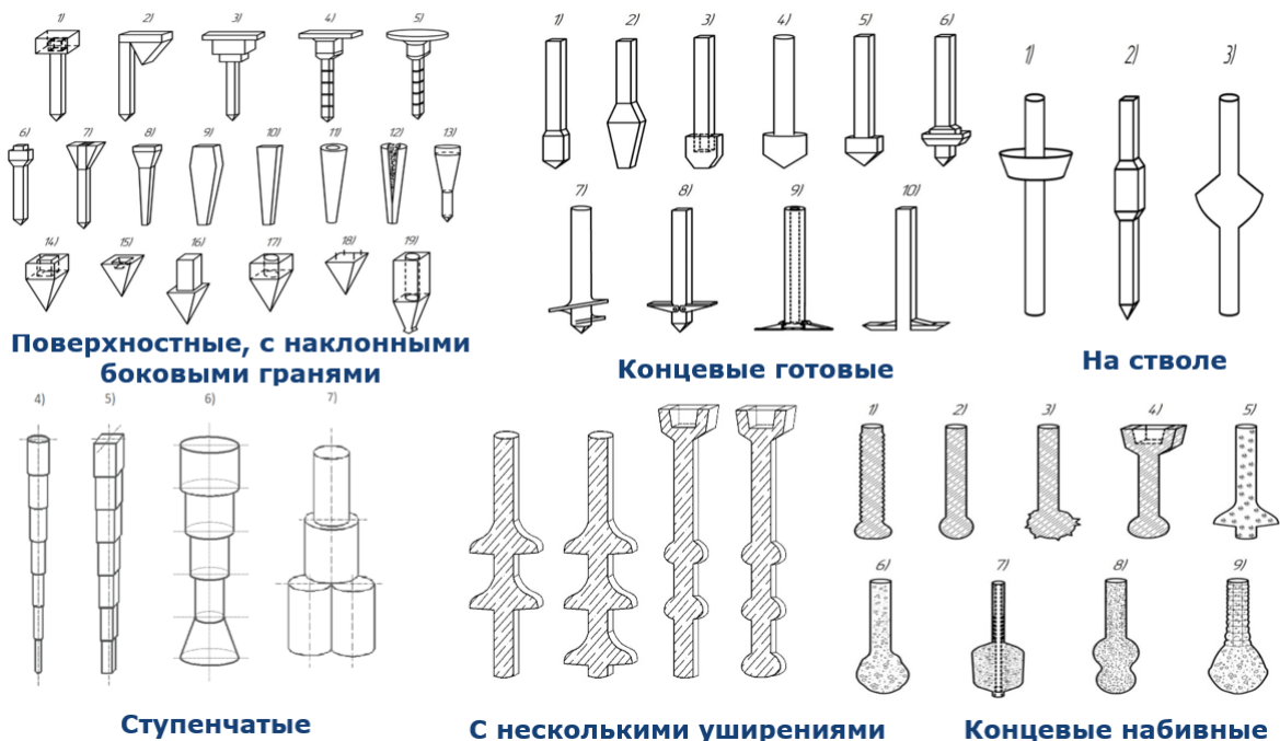
Рис. 2. Конструктивные решения готовых и набивных свай с уширениями
