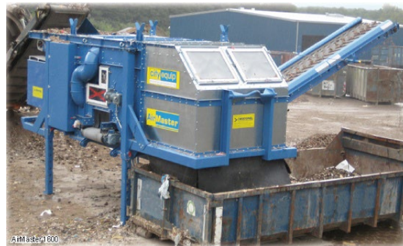
Рис. 2. Аэросепаратор для переработки дробленого строительного мусора [19] Fig. 2. An aerial separator for processing crushed construction debris
