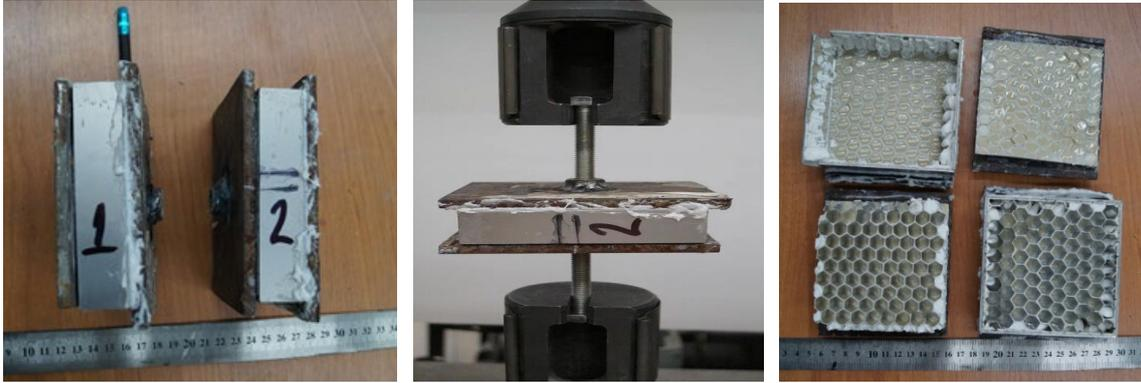
Рис. 4. Подготовка образцов к испытанию, вид образца в испытательной машине и после испытания (иллюстрации авторов)
