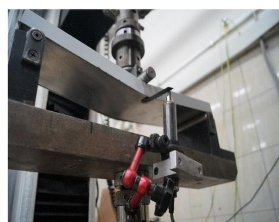
Рис. 3. Образец № 3 алюминиевых панелей с внутренним заполнением из алюминиевых сот на изгиб во время подготовки испытаний на изгибной машине (слева) и во время испытаний на изгиб (справа) (иллюстрации авторов)
