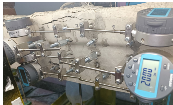
Рис. 5. Измерение продольных деформаций бетона индикаторами после образования трещин и лежачих боковой поверхности (система крепления) (иллюстрация автора)
