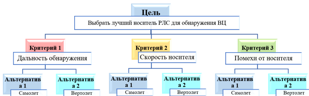
Рис. 1. Иерархическая схема метода выбора эффективного носителя РЛС (иллюстрация авторов) Fig. 1. Hierarchical scheme of the method of selecting an effective radar carrier (illustration by the authors)
